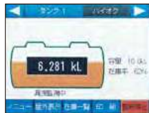
漏洩テスト中の屋内表示計画面 ▲
