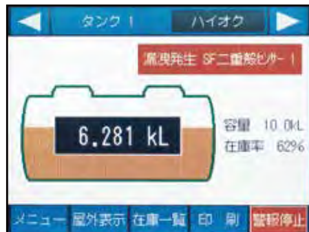
●SF二重殻タンク漏洩検知表示
